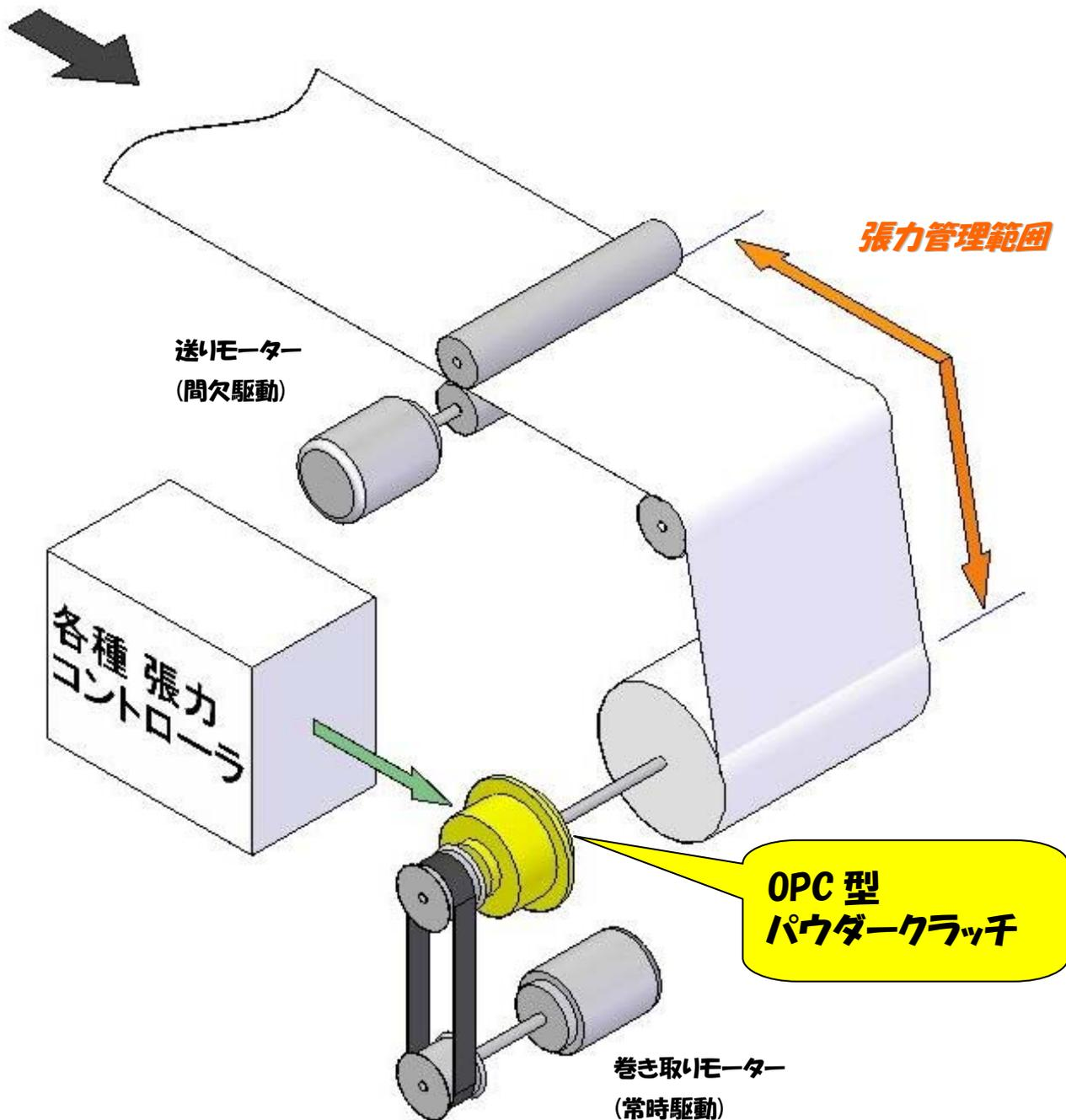
巻き取りの場合は、巻き取りドラムと巻き取りモーター(常時駆動)間に設置した OPC 型パウダークラッチ(ヒステリシスクラッチも可)に通電する電流を調整して、送りモーターによって任意速度で巻き取られるシート材の張力を管理(制御)します。
